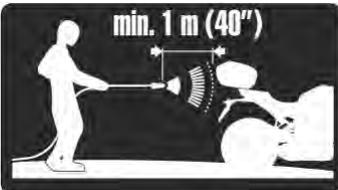
**MIN. 1 METER ABSTAND BEIM REINIGEN MIT EINEM DAMPFSTRAHLER**
